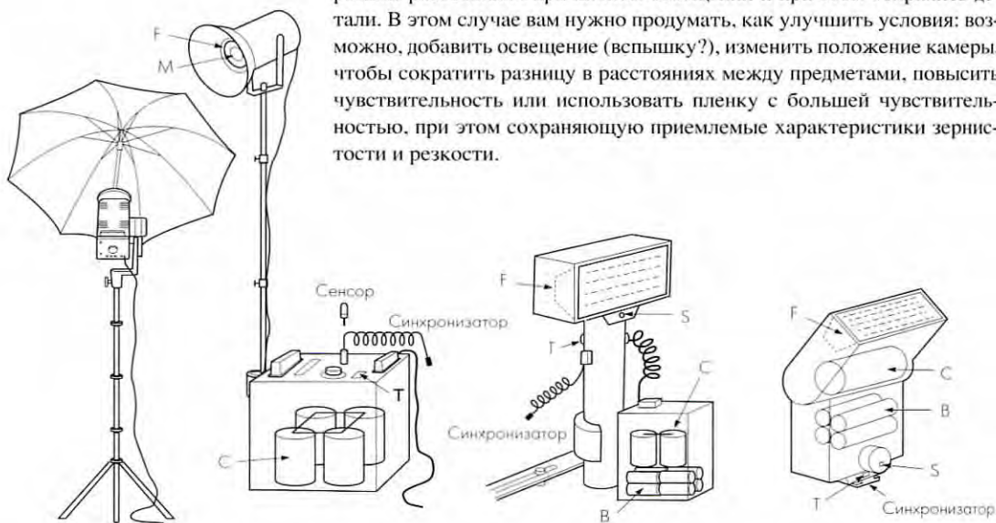
Рис. 10.25. Вспышка. Студийное оборудование и внешние дополнительные вспышки со светочувствительными сенсорами и системой синхронизации. Энергия поступает из батарей (В) или (в случае студийного оборудования) из электросети и заряжает конденсаторы (С). Когда срабатывает спусковая кнопка затвора, тестовая кнопка (Т) на вспышке или световая повушка, на вспышку (F) подается заряд и происходит вспышка. М: галогенная лампа-пилот. S: сенсор-фотоэлемент, измеряющий отраженный от объекта свет и регулирующий длительность вспышки.
