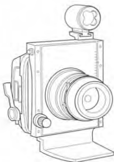
Рис. 4.25. Дальномерные камеры для специальных задач. Сверху: широкоугольная раликовая камера формата 6 × 17 см [фокусировка только по шкале расстояний]. Внизу: камера с шифт-объективом для съемки архитектуры с присоединяемым адаптером для раликовой или листовой пленки.
