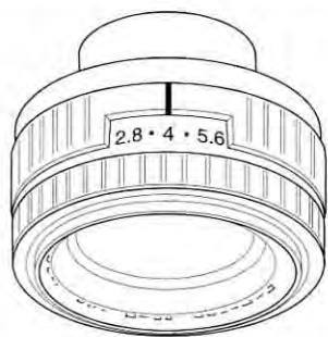
Рис. 12.5. Объектив увеличителя с максимальной диафрагмой f/2,8 . Крупные цифры на шкале и «щелчки» при переходе с одной ступени на другую облегчают его использование в темноте. Выбирайте высококачественный объектив, иначе вся ваша работа будет испорчена.
