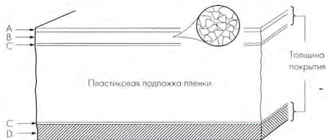
Рис. 9.2. Разрез черно-белой пленки. А: защитное желатиновое покрытие. В: один или несколько слоев эмульсии, содержащей галогениды серебра. С: основа, которая закрепляет эмульсию на подложке. D: желатиновое покрытие, предотвращающее скручивание пленки (может также содержать противореологический слой). Сравните с рис. 6.2.
