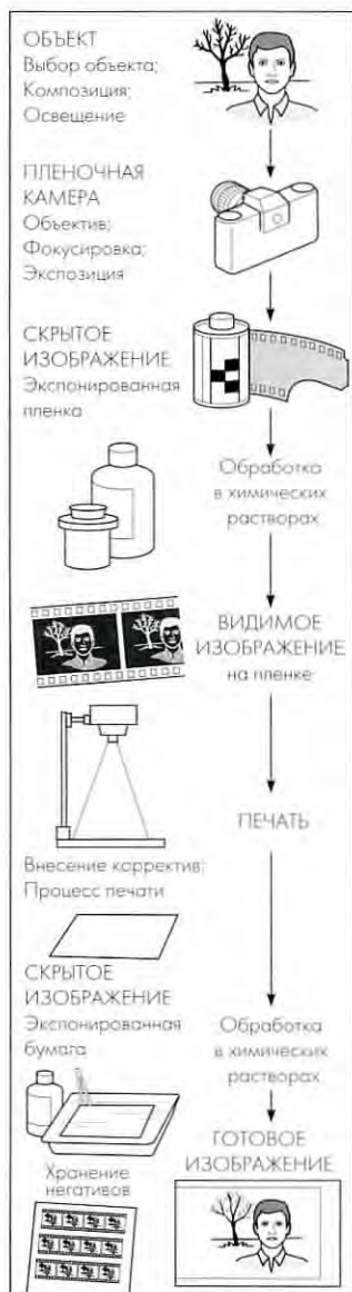
Рис. 1.2. Путь от объекта съемки до готового фотографического отпечатка с использованием пленки. Вам потребуются реактивы и специально оборудованная фотолаборатория.
