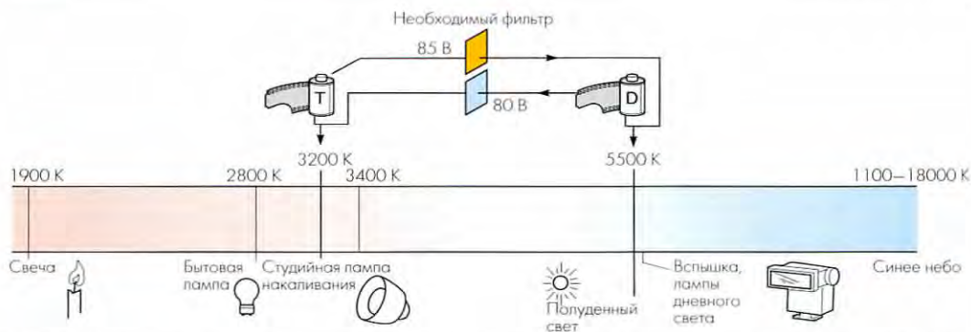
Рис. 7.6. Цвет распространенных источников «белого света», представленный как цветовая температура в кельвинах (K). Дневная пленка (D) требует синий фильтр 80A при использовании с лампой с цветовой температурой 3200 K. Пленку для искусственного света (T) при съемке в условиях дневного света или при вспышке следует применять с фильтром 85B в целях точного отображения цветов. См. также рис. 9.29.
