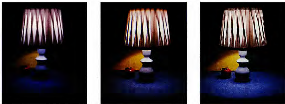
Рис. 2.13. Дырочный «объектив» против настоящего. Снимок слева сделан с помощью корпуса 35-мм зеркальной камеры и кухонной фольги с отверстием диаметром 0,25 мм. Снимок в центре — обычное пластиковое увеличительное стекло, задиафрагмированное до f/8 с помощью отверстия в черном листе бумаги. Снимок справа — штатный 50-мм фотографический объектив с диафрагмой f/11 (см. рис. 3.6). Как показывают ТЛ-замеры камеры, для дырочного объектива требуется выдержка 20 с, для увеличительного стекла 1/60 с, а для объектива — 1/30 с. Если наводить резкость по центру кадра, увеличительное стекло дает плохую резкость по краям. При съемке с дырочным объективом детали по всему полю кадра получаются еще более нерезкими.
