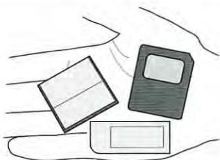
Рис. 6.8. Съёмные флэш-карты для хранения цифровых изображений. Слева: карта CompactFlash, пригодная для камер Kodak, Nikon и др. Внизу в центре: Memory Stick от Sony. Справа: карта SmartMedia, используемая в камерах Fuji, Olympus и др.
