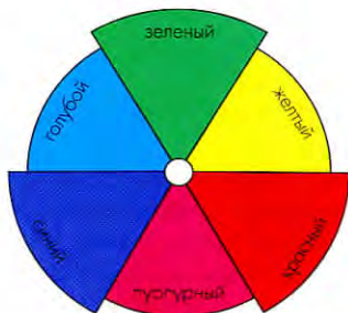
Рис. 9.25. Упрощенная цветовая схема, представляющая световой спектр в форме круга. Выдающиеся сегменты (синий, зеленый и красный) — первичные цвета. Желтый, пурпурный и голубой — добавочные цвета, противоположные первичным (в целях фильтрации).
