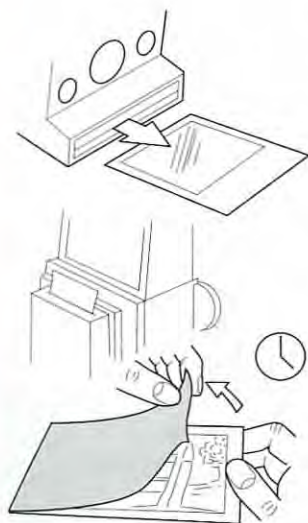
Рис. 9.9. Материалы для одноступенной фотографии. Вверху: цельный тип. Внизу: тип с защитным листом. Упаковка с пленкой прикреплена к камере для роликовой пленки вместо магазина для обычной роликовой пленки.
