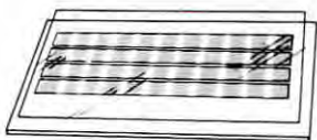
Рис. 13.1. Оборудование для контактной печати. Вверху и в центре: устройства для контактной печати, рассчитанные на 35-мм или 120-мм роль-фильмовые негативы. Полоски вставляются в тонкие прозрачные направляющие с нижней стороны стекла. Снизу: простейшая контактная печать с помощью листового стекла.
