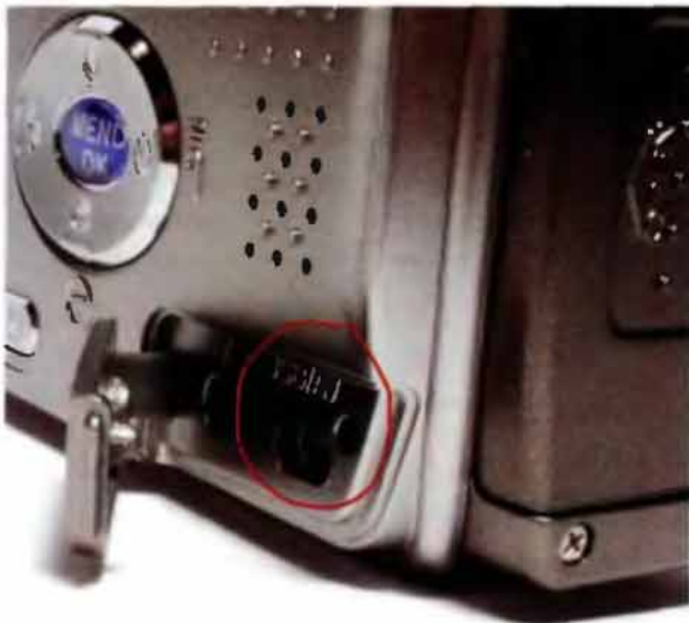
Разъемы интерфейса mini USB и видеовыхода в цифровой камере компактного класса
