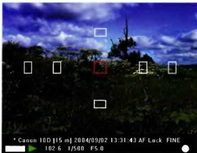
Индикация зон автофокуса на дисплее цифровой фотокамеры
