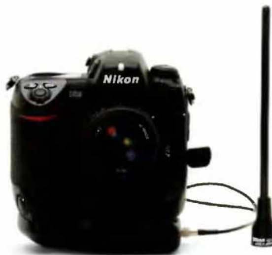
Профессиональная цифровая камера Nikon D2H с подключенным блоком WT-1 беспроводного интерфейса 802.11b/g. Пропускная способность до 11 Мбит/с, радиус действия на открытой местности до 500 метров, в зданиях до 100 метров, рабочая частота 2,4 ГГц
