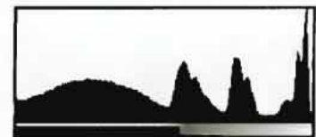
Гистограмма контрастной фотографии имеет насыщенные участки в светах и тенях
