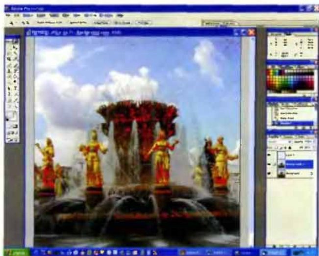
Красные пятна — не дефект снимка, а сигнал программы о том, что не все цвета могут быть достоверно воспроизведены в избранном цветовом пространстве (в нашем примере — в цветовом пространстве принтера Epson 1290)
