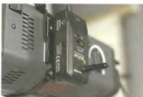
Радиоустройство для беспроводного запуска вспышек, устанавливается на камеру и на каждую вспышку.
