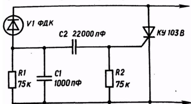
Рис. 111. Принципиальная схема синхронизатора
